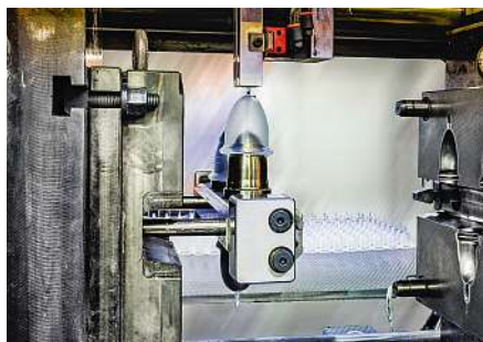
Illustr. : L'injection de LSR permet à Sterne de fabriquer notamment des coupelles menstruelles.
